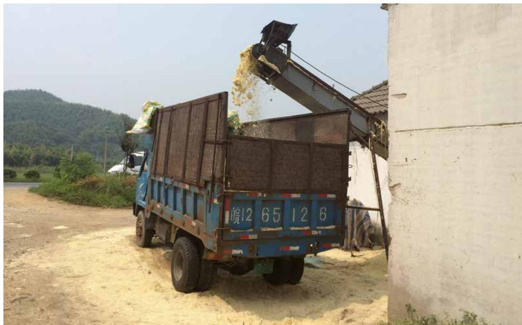
**Figura 3.39.** Grandes cantidades de aserrín provenientes de la fábrica de procesamiento primario son recolectadas automáticamente y depositadas en un camión, para transportarlas a fábricas productoras de tableros aglomerados, pellets para biocombustible y briquetas de carbón (Zhu Zhaohua).
