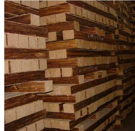
**Figura 3.84** Madera bambú después de prensado en frío (Zhu Zhaohua).
