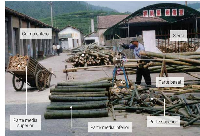
Figura 3.34. Cortes básicos en una fábrica de procesamiento primario en el Condado de Anji, Provincia de Zhejiang, China, 2005 (Zhu Zhaohua)
