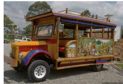
**Figura 2.72 y 2.73.** Bicicleta y bus "chiva" fabricados en bambú/guadua, Colombia. (Zhu Zhaohua)
