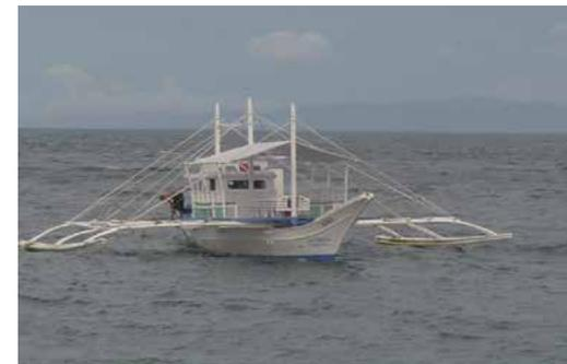
**Figura 2.81.** Bote turístico de bambú en Filipinas. El 70% de los materiales provienen del bambú. (Zhu Zhaohua)
