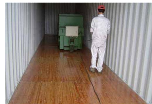
**Figura 2.82.** Piso de bambú en un contenedor. (Zhou G. M, Shi Y. J, 2012).
