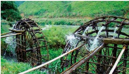
**Figura 2.58. a.b.** Rueda hidráulica de alta velocidad fabricada con bambú (Museo de artículos tejidos en bambú en Qingshen, Provincia de Sichuan, China).
